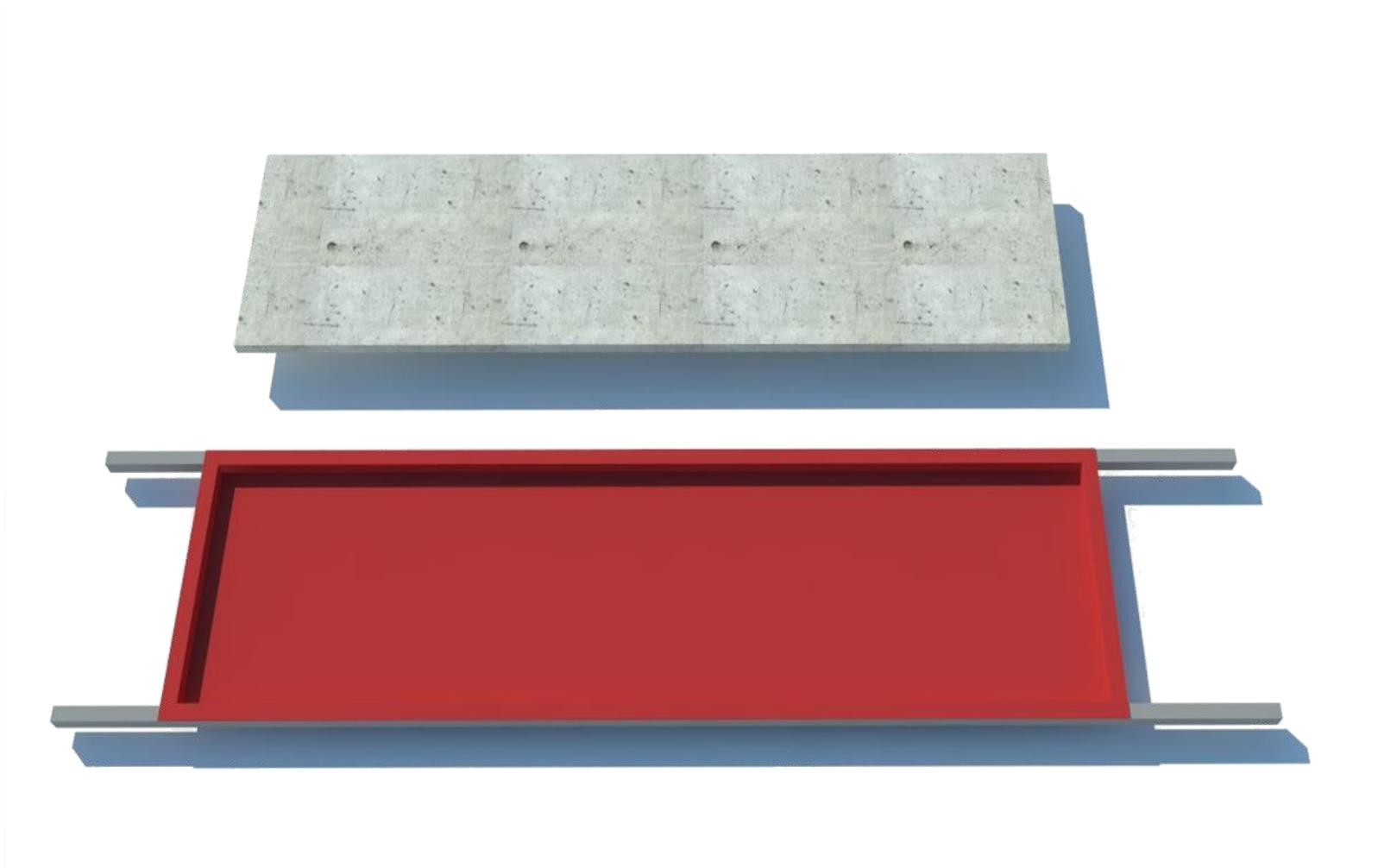
Formas com estrutura em aço revestidas em fibras para fabricar placas pré-moldadas para paredes externas da casa Modelo Tijolinho, possibilitando deixar a parede interna da casa lisa “rente”, o pilar não fica exposto internamente, tendo mais agilidade, economia na obra e melhor design do acabamento interno, possibilitando também fazer paredes duplas de 12 cm de espessura.
